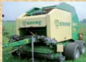
Krone Vario Pack 1800 MC , Bj. 2005, 13900 Ballen, Netz, 17 Messer, Zentralschmierung
