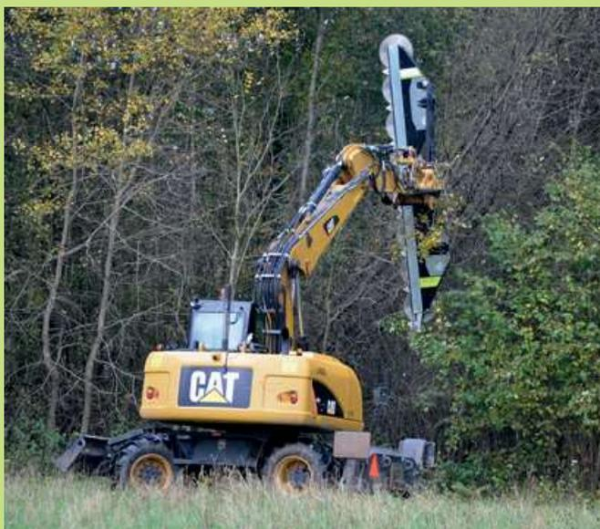
Soll es nicht nur groß, sondern wirklich groß sein, dann bieten wir die weltweit größte Säge mit 4,0 m bzw. 4,8 m Arbeitsbreite an. Die Säge kann an größeren Baggern oder Ladern betrieben werden, für die das Gewicht der Säge keine Schwierigkeit ist.
