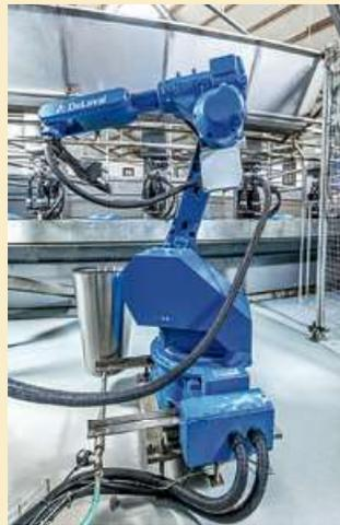
Und der DeLaval Zitzen-Sprayroboter TSR, welcher deutlich zur Reduzierung der Arbeitskosten am Melkkarussell beiträgt. Der TSR ist ein eigenständiges, auf einem Industrieroboter basierendes System.
