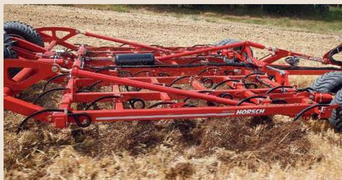
Alle Maschinen laufen bei Straßentransport auf einem Fahrwerk, welches bei den 5,6 und 7 XL auch zum Drehen am Vorgewende genutzt wird. Die großen Baureihen drehen am Vorgewende auf dem Packer.
