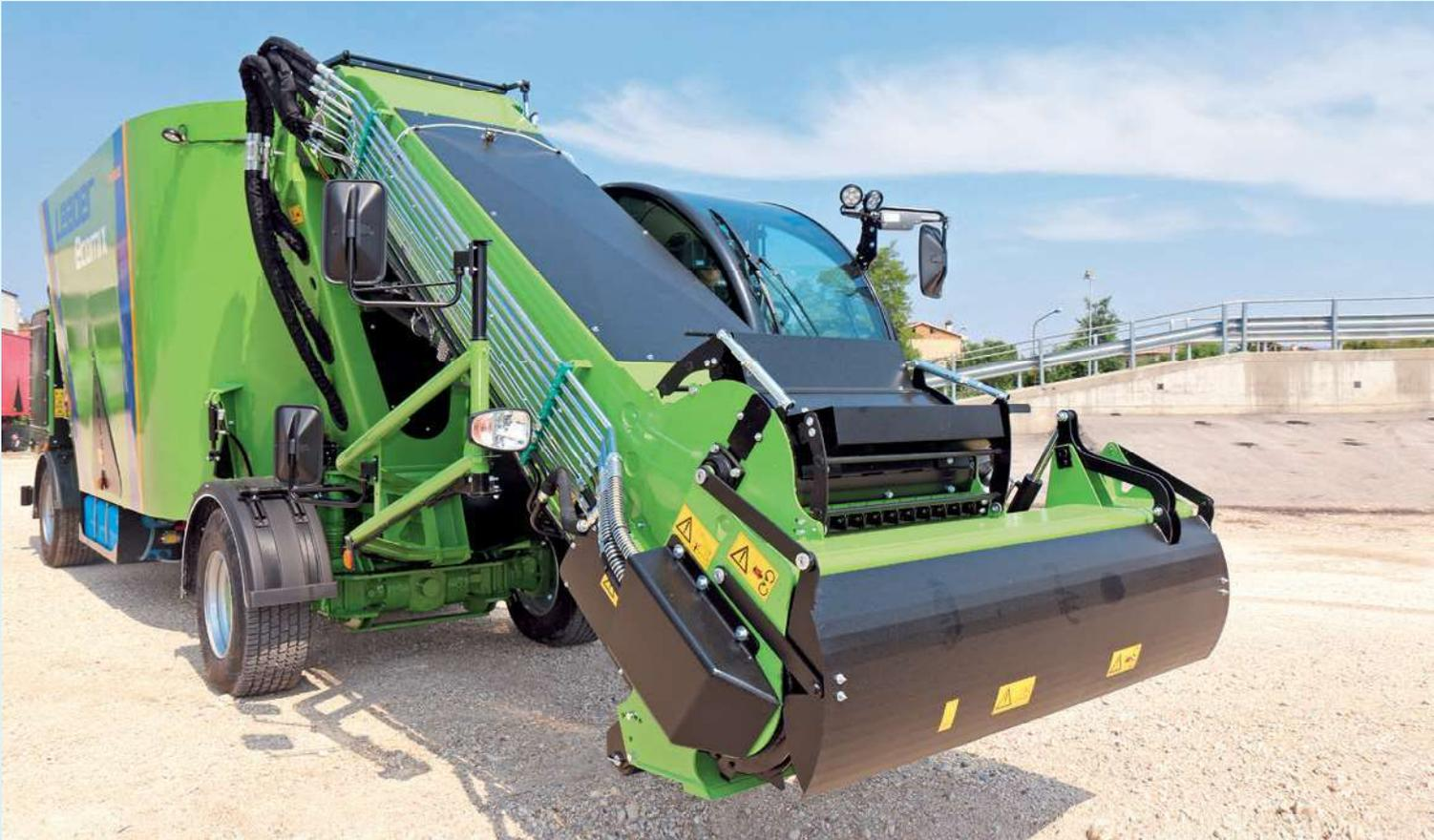
Die Entwicklung der Maschine hat technische NEUHEITEN wie eine Abdeckung des Mischbehälters, einen zusätzlichen Strohhäcksler und vor allem eine neue großzügige bedienerfreundliche Kabine.
