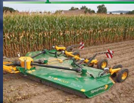
der Rotormulcher Spearhead Star Cut 730 seine Stärken vor allem in der Schlagkraft, im geringeren Kraftbedarf und beim niedrigeren Dieselverbrauch pro Hektar aus. Bezogen auf die für die Maisstoppelbearbeitung anfallenden Maschinenkosten pro Hektar haben Praxisvergleiche gezeigt, dass der Rotormulcher diesen Arbeitsgang kostengünstiger erledigen kann.
