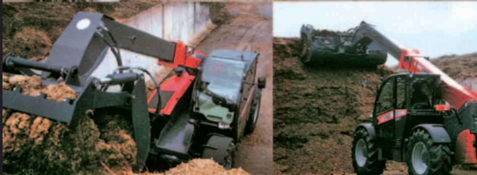
Auf der Sima in Paris präsentierte Massey Ferguson erstmalig seine neue Teleskopladerserie MF 9000, die mit ihrem neuen Design aber auch mit den neuen Funktionen überzeugen. Die vier neuen Modelle (2,2 – 3,5 t Hubkraft/5,2 – 7m Hubhöhe / 75 – 130 PS) ersetzen die bisherigen Modelle, mit Ausnahme des erst kürzlich für Spezialeinsätze eingeführten Topmodells MF 89410 (3,5 t / 10 m).
