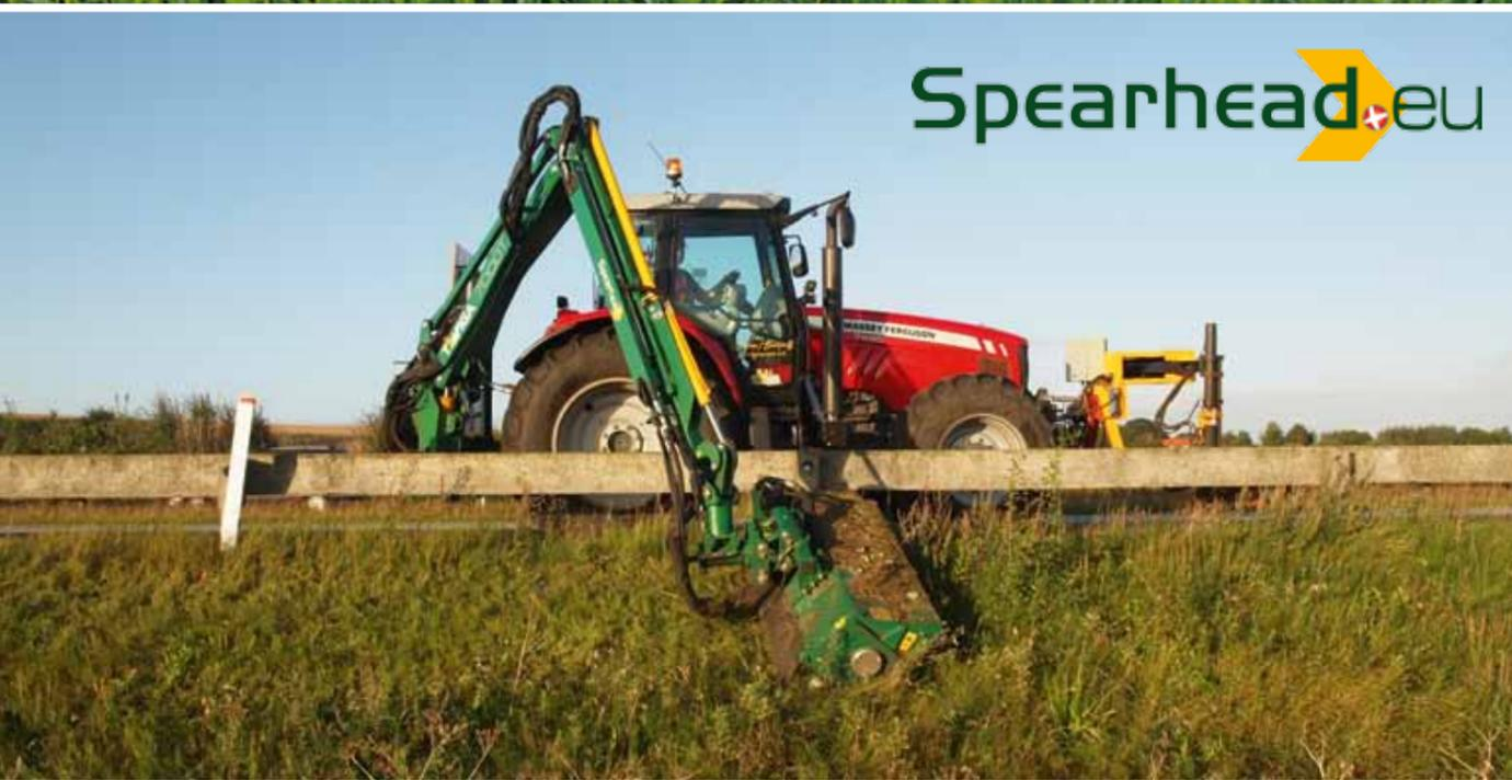
Als Profi in der Konstruktion von Auslegermähern hat der Hersteller Spearhead erfolgreich die neue Baureihe TWIGA Flex eingeführt. Durch die Drehpunktverlagerung des Auslegerarms am Grundrahmen um 70 cm nach außen ergeben sich vielfältige neue Einsatzmöglichkeiten. Der Ausleger kann bei der Heckmontage des Gerätes um 50° nach vorn und 90° nach hinten geschwenkt werden. In Verbindung mit dem
