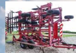
**Horsch FG 10.0**, Bj. 2001, AB 10 m, 33 Zinken mit Federsteinsicherung
