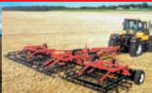
Der Jumbo ST 8 ist ein schwerer Striegel zur Verteilung von Stroh.
