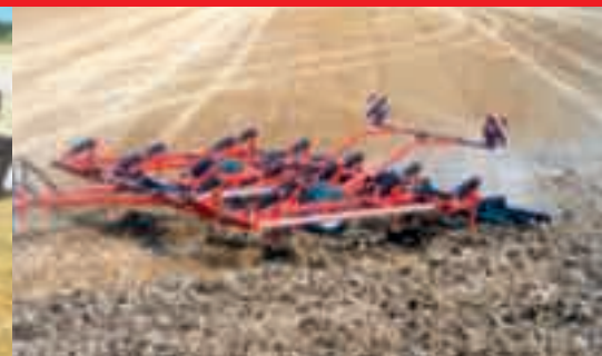
Mit dem Terrano FG kann zwischen drei und 20 Zentimeter tief gearbeitet werden.
