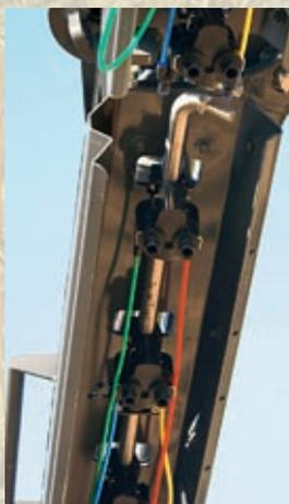
Sicherer Schutz der Düsen, Düsenkörper und Leitungen vor Beschädigungen durch das Gestängeprofil.
