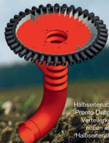
Halbseitenabschaltung: Pronto-Drillmaschinen-Verteilerkopf mit der neuen elektrischen Halbseitenabschaltung
