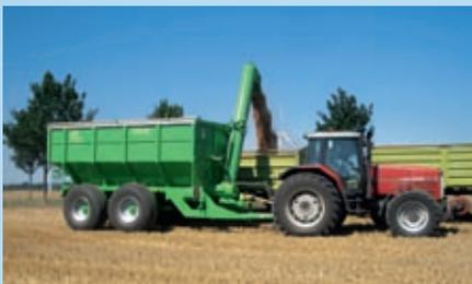
Das zweite Geschäftsfeld der Güstrower sind seit einigen Jahren **Überladewagen**. Die Produktpalette sind Einachser mit 21 m<sup>3</sup> (GTU 21), Tandemachsgeräte mit 25 m<sup>3</sup> (GTU 25) und Tridemachsgeräte mit 32 m<sup>3</sup> (GTU 32).
