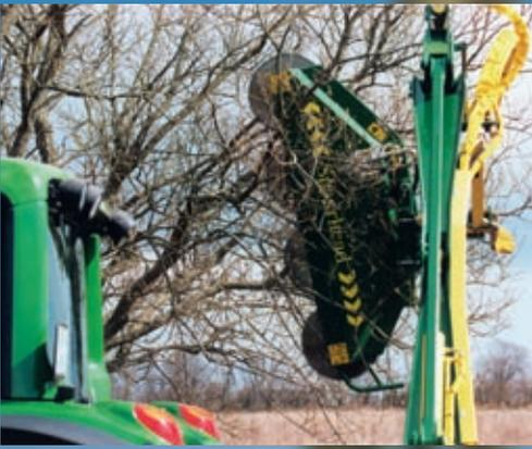
Bei günstigen Arbeitsverhältnissen kann die Baumsäge mit bis zu 5 km/h gefahren werden, wodurch eine hohe Schlagkraft erreicht wird.
