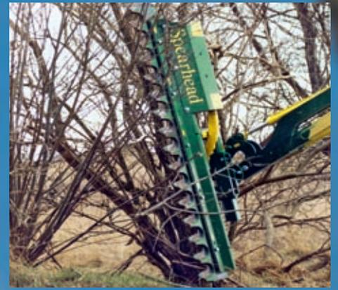
Bei Ästen mit einem Durchmesser von bis zu sechs Zentimetern schneidet die Astschere problemlos.
