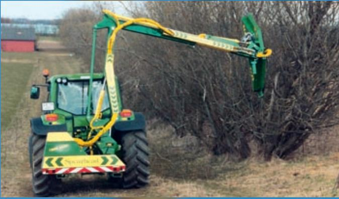
Sowohl die Astschere als auch die Kreissäge werden am besten über einen Auslegerarm betrieben. Alternativ ist die Montage am Bagger oder ähnlichen Trägerfahrzeugen möglich.
